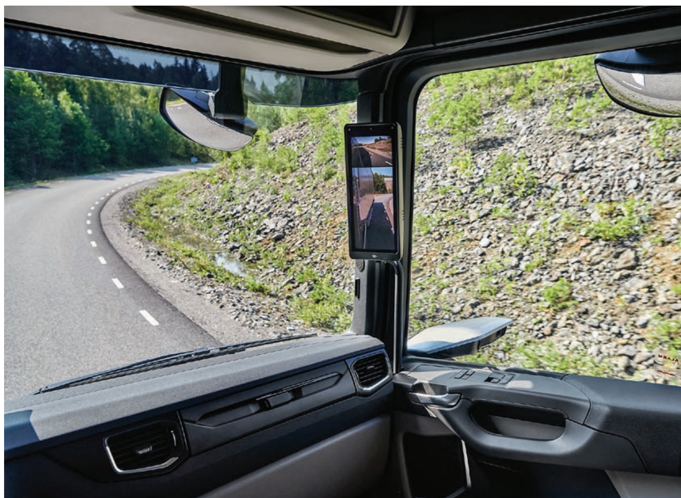
Die Mirror-Cam bei Lastwagen – eine Kamera mit Bildschirm anstelle der Rückspiegel.
